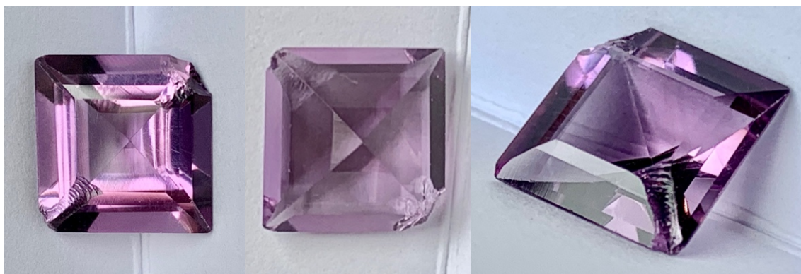
Figura 1 - Ametista quadrada quebrada em três vértices. Da esquerda para a direita: vista superior, posterior e inclinada. Fonte: Foto de Andressa Borotti.
