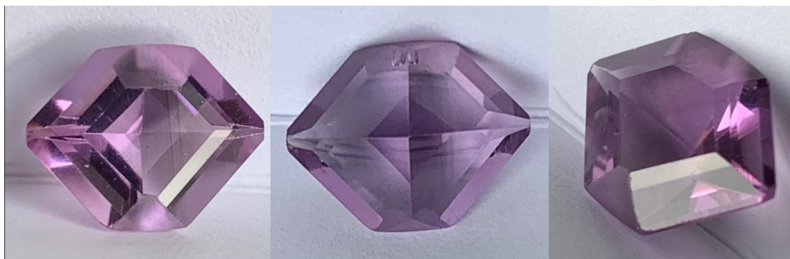
Figura 3 - Ametista reconfigurada. Da esquerda para a direita: vista superior, posterior e inclinada. Dimensões e peso final: 9,30 mm x 9,80 mm x 9,95 mm x 13,10 mm x 5,80 mm, 3,20 quilates (ct).
